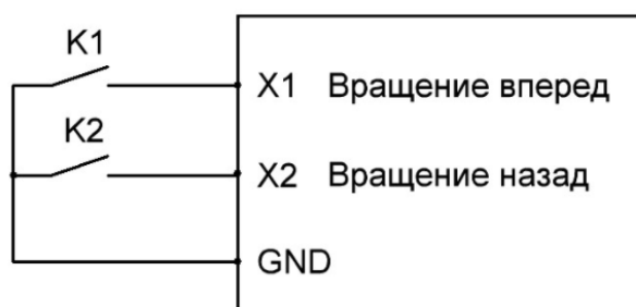
Рис. 5-11 Принципиальная схема двухпроводного режима работы
