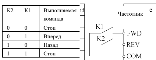
Рис.6-13 Двухпроводной режим управления 1
