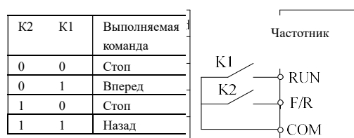
Рис. 6-14 Двухпроводной режим управления 2
